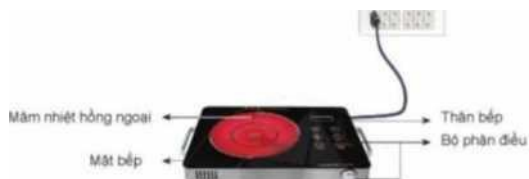
Hình 13.4. Cấu tạo của bếp hồng ngoại
