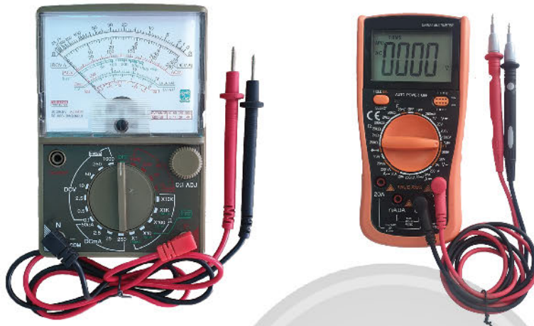
a) Đồng hồ vạn năng hiển thị kim b) Đồng hồ vạn năng hiển thị số
