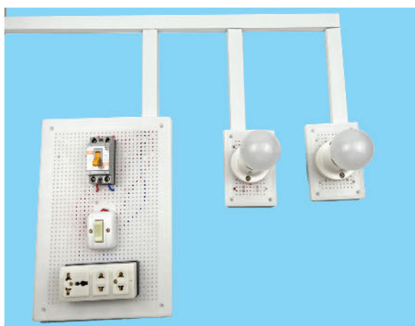
Hình 6.8. Mô hình mạch điện điều khiển hai bóng đèn luân phiên
