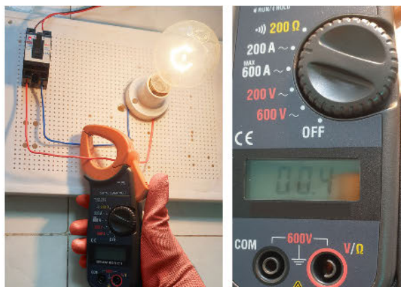
Hình 2.5. Sử dụng ampe kim đo cường độ dòng điện xoay chiều
