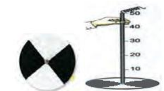
Hình 13.8. Cấu tạo đĩa Secchi
