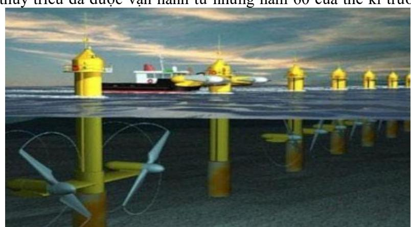
Một máy phát điện thủy triều khi hoạt động, nếu trong mỗi giây có  $9,7 \times 10^5$  kg nước biển chảy vào mỗi tua bin với tốc độ  $3,0 \text{ m/s}$  và chảy ra với tốc độ  $1,0 \text{ m/s}$  thì tạo ra công suất điện đối với mỗi tua bin là  $1,2 \times 10^6 \text{ W}$ . Coi công suất dòng nước cung cấp cho mỗi tuabin bằng hiệu số động năng của dòng nước chảy vào tuabin và chảy ra khỏi tuabin trong một giây.
