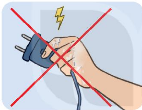
Hình 10.3. Không cầm điện khi tay hoặc người bị ướt, tránh bị điện giật
