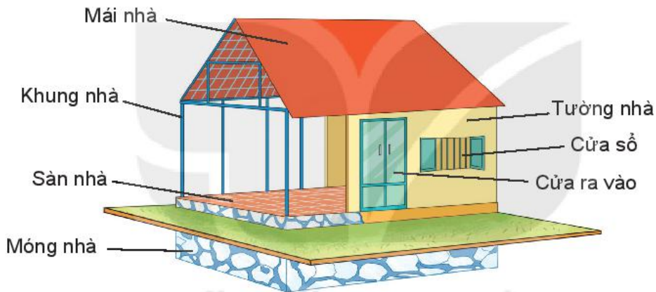
Hình 1.2. Cấu tạo chung của nhà ở
