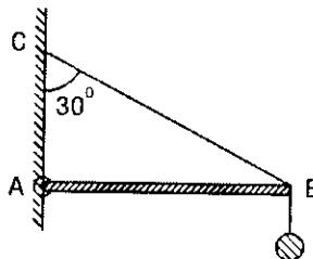
Một ngọn đèn khối lượng  $m = 4\text{kg}$  được treo vào tường bởi dây BC và thanh AB. Thanh AB gắn vào tường bằng bản lề A,  $\hat{C} = \alpha = 30^\circ$ .
