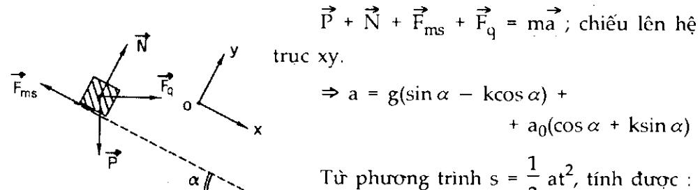
$$\vec{P} + \vec{N} + \vec{F}_{ms} + \vec{F}_q = m \vec{a} ; \text{ chiếu lên hệ trục xy.}$$
