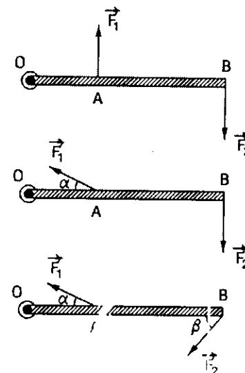
Thanh nhẹ OB có thể quay quanh O. Tác dụng lên thanh các lực  $\vec{F}_1$ ,  $\vec{F}_2$  đặt tại A và B. Biết  $F_1 = 20\text{N}$ ,  $OA = 10\text{cm}$ ,  $AB = 40\text{cm}$ . Thanh cân bằng,  $\vec{F}_1$  và  $\vec{F}_2$  hợp với AB các góc  $\alpha$ ,  $\beta$ .
