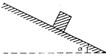
Khối hộp đáy vuông cạnh  $a = 0,5\text{m}$  chiều cao  $b = 1\text{m}$  được đặt trên mặt phẳng nghiêng, hệ số ma sát giữa vật và mặt nghiêng là  $k = 0,4$ . Khi tăng dần  $\alpha$ , khối hộp sẽ trượt hay đổ trước?
