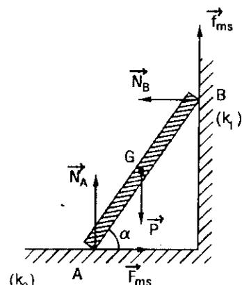
– Cân bằng đối với trục quay qua B cho :
