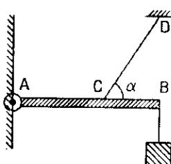
Thanh AB khối lượng  $m_1 = 10\text{kg}$ , chiều dài  $l = 3\text{m}$  gắn vào tường bởi bản lề A. Đầu B của thanh treo vật nặng  $m_2 = 5\text{kg}$ . Thanh được giữ cân bằng nằm ngang nhờ dây treo CD; góc  $\alpha = 45^\circ$ . Tìm các lực tác dụng lên thanh AB biết  $AC = 2\text{m}$ .
