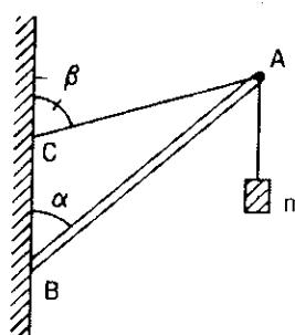
Vật  $m = 20kg$  được giữ vào tường nhờ dây treo AC và thanh nhẹ AB. Cho  $\alpha = 45^\circ$ ,  $\beta = 60^\circ$ .
