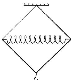
Một hệ cơ có cấu tạo như hình vẽ gồm 4 thanh nhẹ nối với nhau bằng các khớp và một lò xo nhẹ. Khi chưa treo  $m$ , các thanh tạo thành hình vuông và chiều dài lò xo là  $l = 9,8\text{cm}$ . Khi treo  $m = 500\text{g}$  góc nhọn giữa các thanh là  $\alpha = 60^\circ$ .
