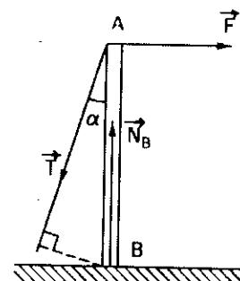
Cân bằng đối với trục quay ở B cho :
