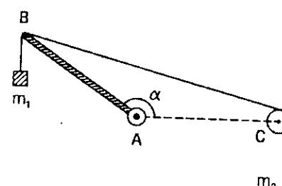
Thanh đồng chất AB có thể quay quanh bản lề A. Hai vật có các khối lượng  $m_1 = 1\text{kg}$ ,  $m_2 = 2\text{kg}$  được treo vào B bằng hai sợi dây như hình vẽ. (C là ròng rọc nhẹ). Biết  $AB = AC$ , khối lượng thanh là 2kg.
