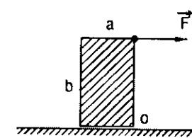
Tìm lực F cần để làm quay vật hình hộp đồng chất  $m = 10\text{kg}$  quanh O như hình vẽ.
