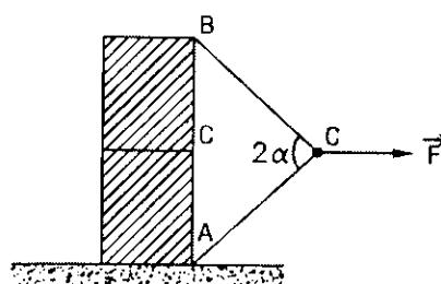
Hai khối vuông giống nhau, khối lượng mỗi khối là M, được kéo bởi lực  $\vec{F}$  qua hai dây nối AC = BC như hình vẽ. Góc ACB =  $2\alpha$ . Hệ số ma sát giữa hai khối là k, khối M ở dưới gắn chặt với đất.
