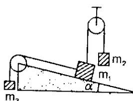
Cho hệ cân bằng như hình vẽ,  $m_1 = 3kg$ ;  $m_2 = 1kg$ ,  $\alpha = 30^\circ$ . Bỏ qua ma sát.
