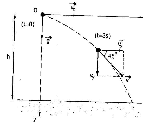
Áp dụng phương pháp tọa độ với hệ trục Oxy
