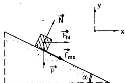
Với vận tốc tối đa, có thể coi  $F_{ms} \approx kN$
