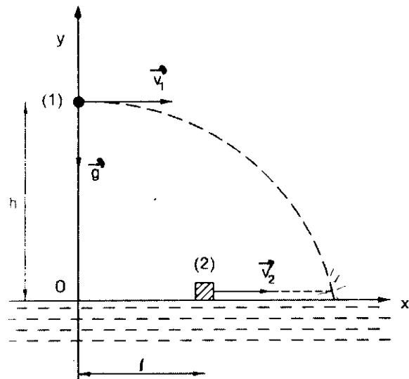
Bom là vật ném ngang ở độ cao h. Áp dụng phương pháp tọa độ với hệ trục Oxy
