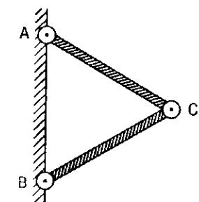
24.14\*Hai thanh AB, BC đồng chất, tiết diện đều, có cùng trọng lượng  $P = 10\text{N}$  gắn với nhau và với tường tại ba khớp A, B, C. Tam giác ABC đều và nằm trong mặt phẳng thẳng đứng.
