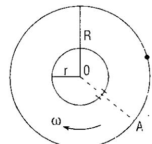
Một dụng cụ để đo vận tốc phân tử có cấu tạo như hình vẽ. Một dây phủ Ag đặt theo trục O của hai ống hình trụ có bán kính  $r$ ,  $R$ . Dây này được đốt nóng bằng dòng điện để phóng ra các nguyên tử Ag.
