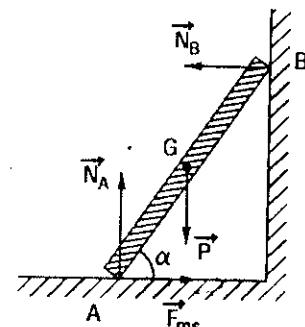
b) Điều kiện :  $F_{ms} < k \cdot N_A$ . Theo lý luận ở câu a) (với  $\alpha$  thay đổi) :
