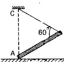
Thanh AB có đầu A tựa trên sàn, đầu B được treo bởi dây BC. Biết BC = AB = a
