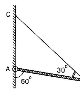
Thanh đồng chất AB có  $m = 2\text{kg}$ , gắn vào tường nhờ bản lề A và giữ nghiêng góc  $60^\circ$  với tường nhờ dây BC tạo với AB góc  $30^\circ$ . Xác định độ lớn và hướng lực đàn hồi của bản lề đặt lên AB.
