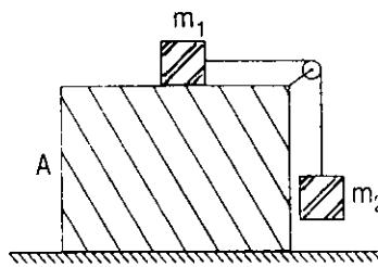
Cho hệ như hình vẽ. Biết  $m_1 = m_2$  hệ số ma sát giữa A với  $m_1, m_2$  là  $k < 1$ .
