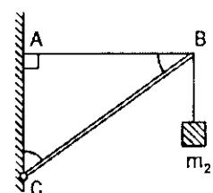
Thanh BC khối lượng  $m_1 = 2kg$ , gắn vào tường bởi bản lề C. Đầu B treo vật nặng có khối lượng  $m_2 = 2kg$  và được giữ cân bằng nhờ dây AB. A được cột chặt vào tường. Biết  $AB \perp AC$ ,  $AB = AC$ .
