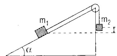
Cho hệ thống như hình vẽ :  $m_1 = 3kg, m_2 = 2kg, \alpha = 30^\circ$ . Ban đầu  $m_1$  được giữ ở vị trí thấp hơn  $m_2$  một đoạn  $h = 0,75m$ . Thả cho hai vật chuyển động.
