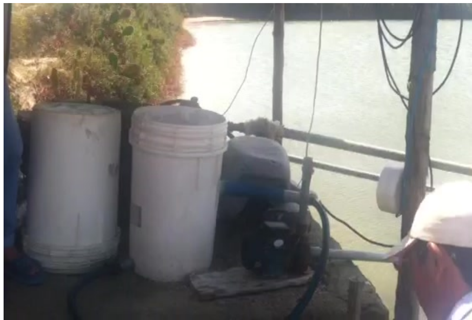
Thùng chứa vôi đã gắn máy bơm và ống dẫn nước vào
