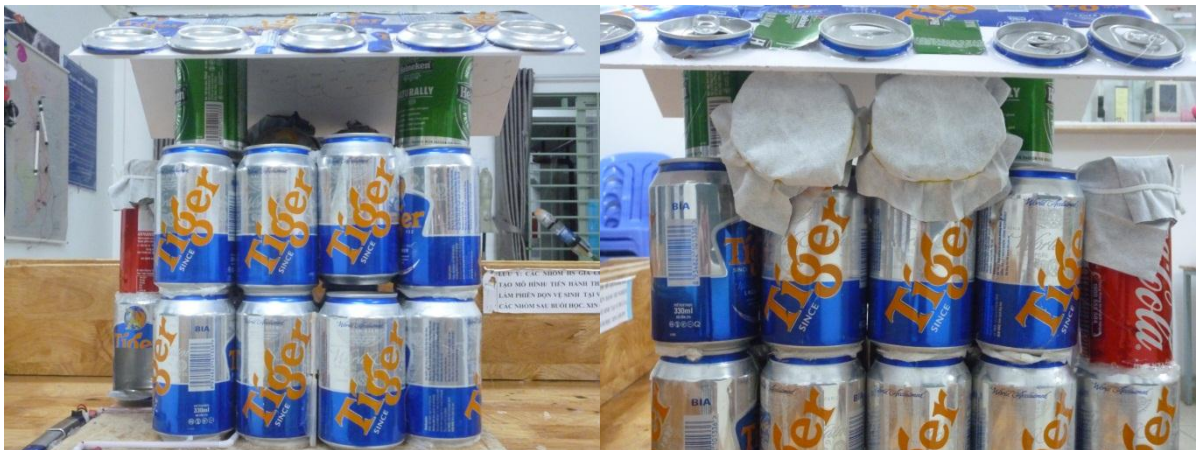
Hình 8.3. Mô hình lọc khói, bụi cho gia đình bằng than hoạt tính
