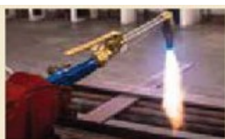
Hình 16.4. Đèn xì oxygen – acetylene
