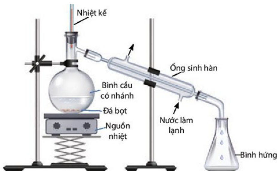
Hình 11.2. Thiết bị, dụng cụ tách chất bằng phương pháp chưng cất thường
