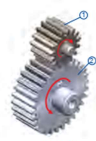
Hình 8.6. Bộ truyền bánh răng 1. Bánh răng dẫn; 2. Bánh răng bị dẫn.
