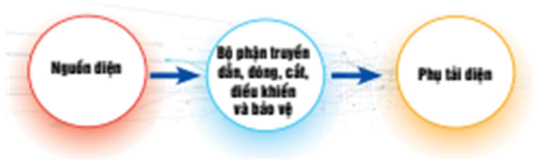
Hình 15. Sơ đồ cấu trúc mạch điện
