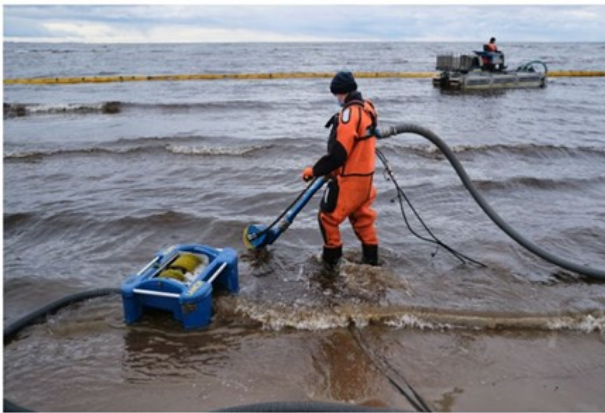
Hình 9.3. Sử dụng rào chắn để thu gom và xử lý dầu tràn
