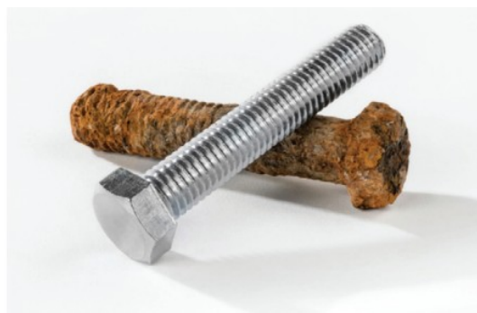
b) Bu lông bị gỉ sét Phản ứng xảy ra chậm
