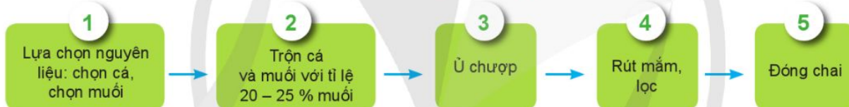
Hình 21.3. Các bước chế biến nước mắm
