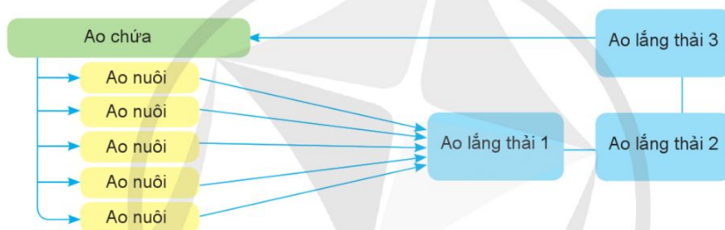
Hình 13.2. Sử dụng ao lắng để xử lý nước trong trại nuôi thủy sản
