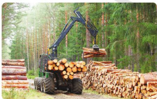
a. Máy thu gom gỗ
