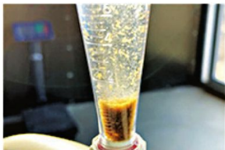
Hình 20.4. Dụng cụ đo mật độ biofloc
