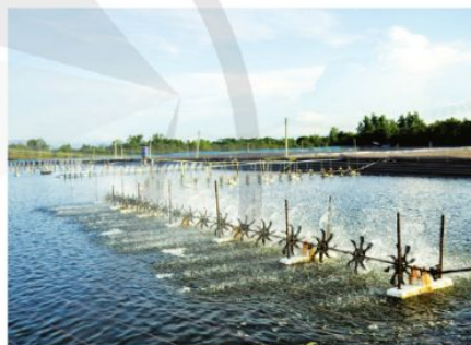
Hình 12.2. Thiết bị quạt nước lắp đặt trong ao nuôi thủy sản
