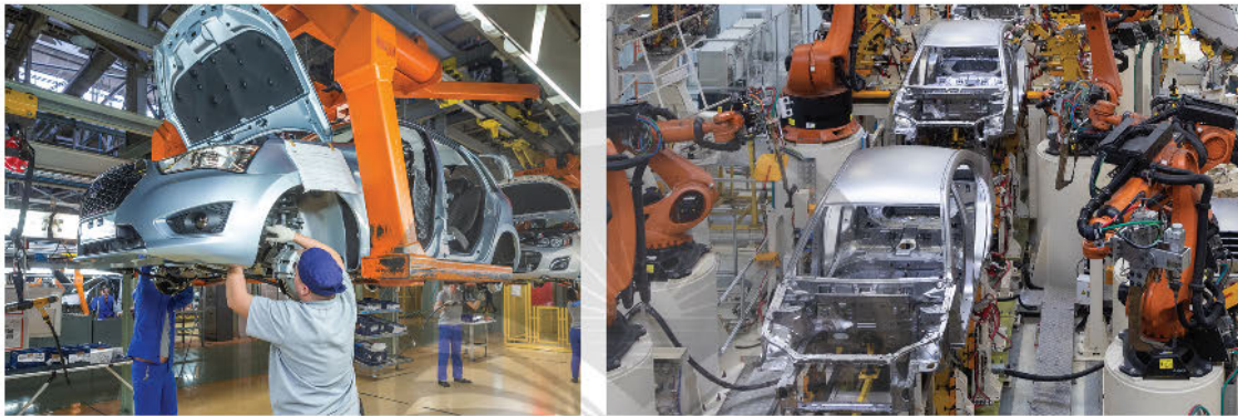
a) Dây chuyền lắp ráp ô tô có sự tham gia của con người
