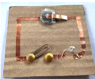
Mở công tắc
