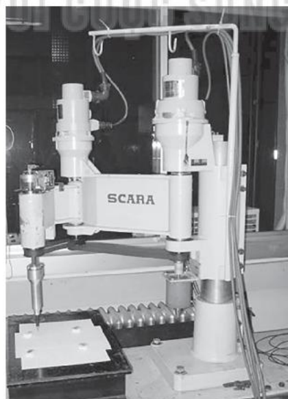
Hình 1.3. Robot SCARA đầu tiên phát minh bởi Hiroshi Makino năm 1978
