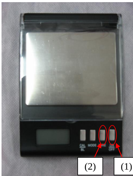
Hình 2: Cân hiện số (1) Nút Bật/Tắt (On/Off) (2) Nút “Tare” – để đưa số chỉ về số không, khi có vật đặt trên cân.
