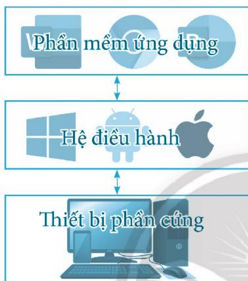
Hình 1. Phần mềm ứng dụng tương tác với thiết bị phần cứng thông qua hệ điều hành
