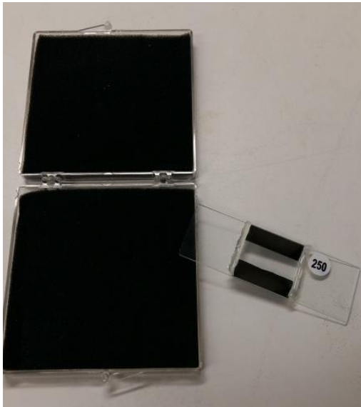
Hình 6: Hộp chứa mẫu và một mẫu chuẩn Fabry-Perot (FP) phủ Titan (Ti) (số của mẫu trong hình vẽ là 250 chỉ để minh họa).
