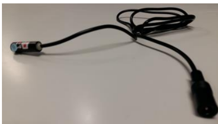
Hình 6: Điốt laze 0.5 mW, bước sóng 650 nm (Loại II).
