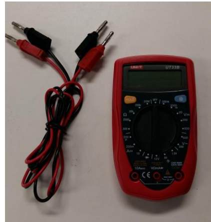
Hình 5: Đồng hồ đo điện đa năng hiện số và dây nối
