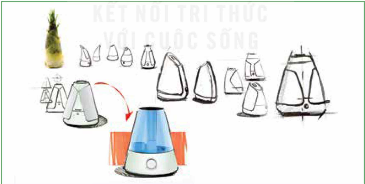
Phác thảo thiết kế kiểu dáng máy tạo độ ẩm không khí dùng trong gia đình (2)
