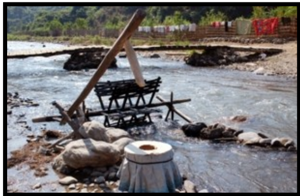
Hình 19.9. Chày giã gạo bằng sức nước
