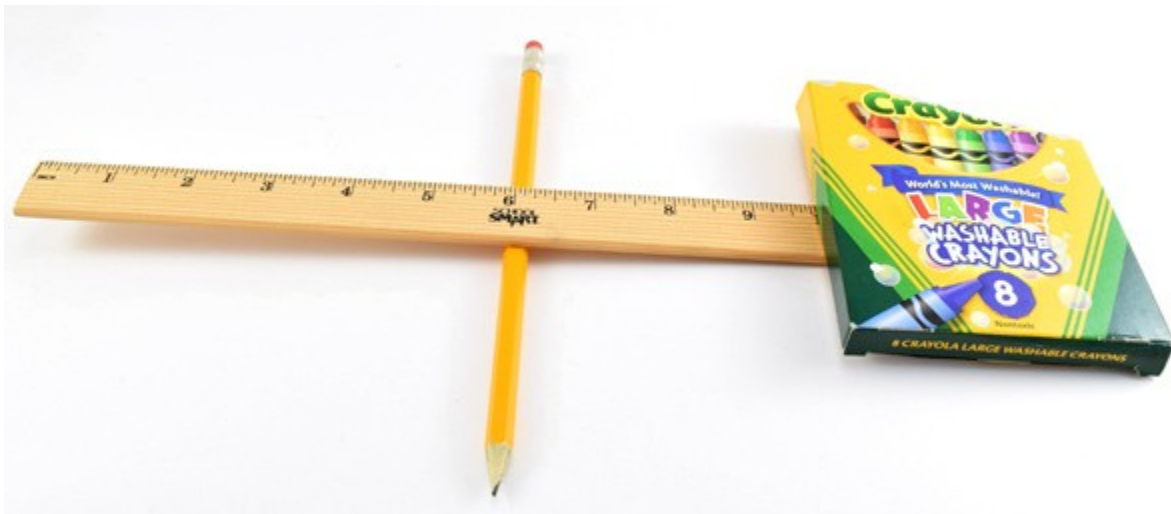
Hình 19.2. Đòn bẩy đơn giản được tạo ra từ bút chì và thước
