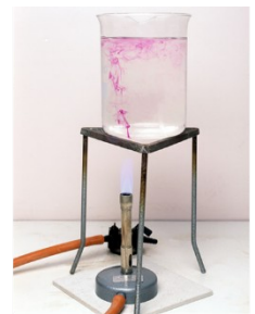
Hình 25.2. Cốc nước có thuốc tím được đun nóng
