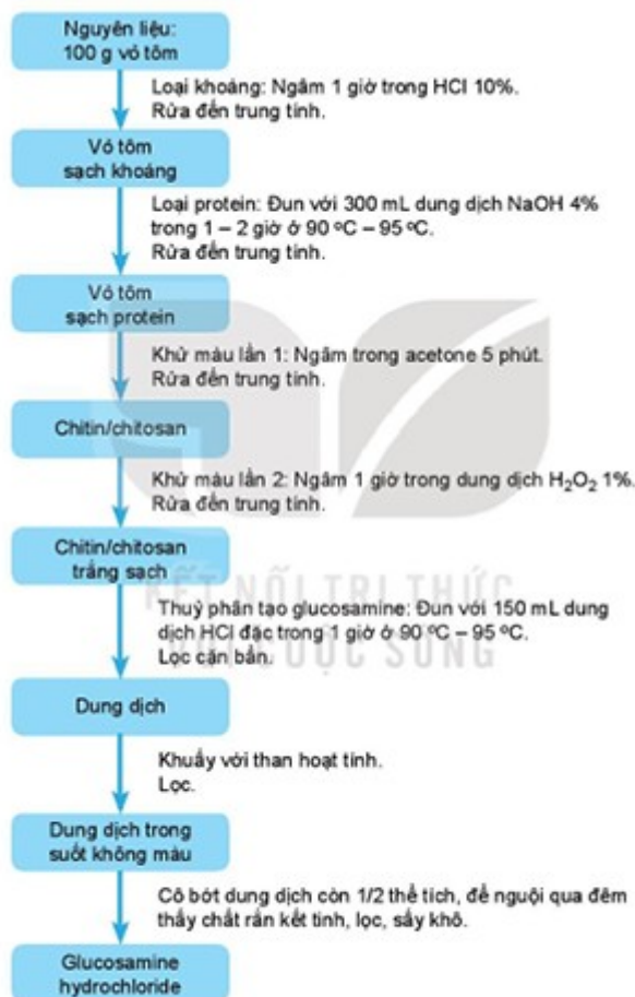
Hình 6.3. Sơ đồ điều chế glucosamine hydrochloride từ vỏ tôm
