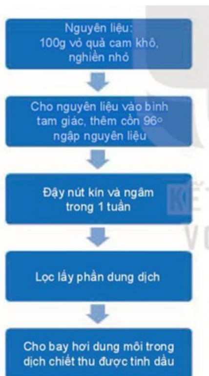
Hình 4.2. Sơ đồ tách tinh dầu vỏ cam bằng phương pháp ngâm chiết
